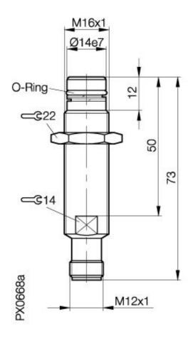
Induktiver Näherungsschalter BES 516-300-S 152-S 4-D M16x1 x 73 Schließer Sn=1,5mm bündig einbaubar öldruckfest bis 350 bar
